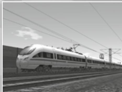
Die Baureihe 415 ist die fünfteilige Variante des ICE-T und ist ein Analogon zur ersten Bauserie der Baureihe 411. Um das modulare Antriebskonzept auf 5 Fahrzeuge zu verteilen, war eine zusätzliche Variante des Stromrichterwagens zu entwickeln. Statt eines BordRestaurants verfügt der Zug lediglich über ein BordBistro. Die Baureihe 415 kommt vorrangig auf der Achse Dresden-Frankfurt-Wiesbaden zum Einsatz. Zeitweise fuhr die Baureihe 415 auch im Schweizverkehr, dabei waren die
