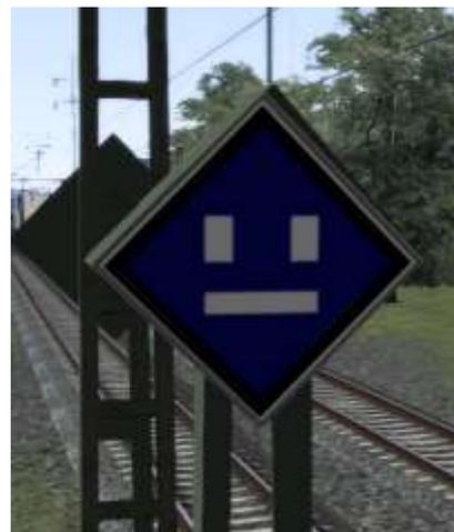
El 2 **„Einschalten“** des Hauptschalters der E-Lok. Bei der S-Bahn bedeutet das Wiedereinschalten des Fahrschalters ist ab hier erlaubt.
