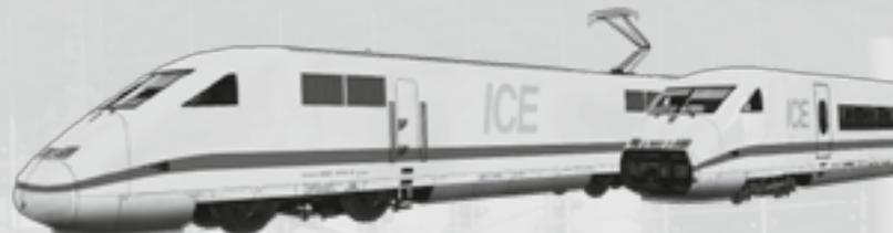
Aufbauend auf die ICEs der ersten Generation, werden seit 1996 die Züge des Typs ICE2 eingesetzt. Die Ähnlichkeit mit ihren Vorgängern lässt sich nicht leugnen und so ist es hauptsächlich das umgesetzte Flügelzugkonzept, was die beiden Fahrzeuggenerationen unterscheidet. Ein Halbzug wird aus einem Triebkopf, 6 Mittelwagen und einem Steuerwagen gebildet.
