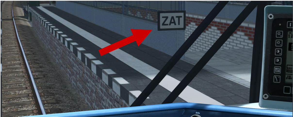
Abbildung: ZAT-Tafel am Bahnsteig zur Signalisierung des Abfertigungsmodus.
